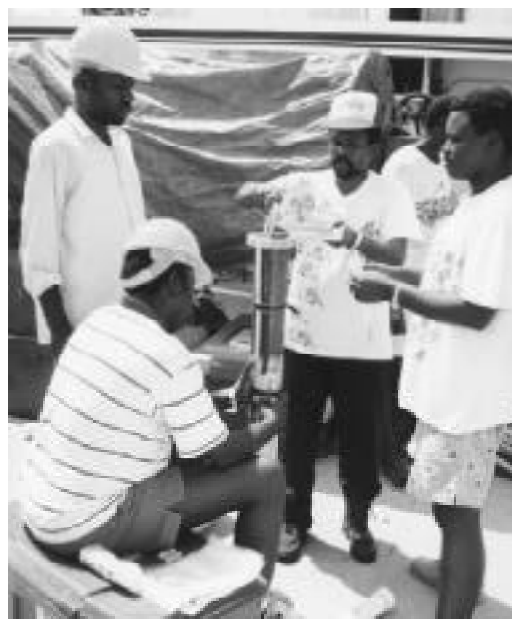
Extraction d'une carotte-échantillon destinée à être traitée et expédiée.
